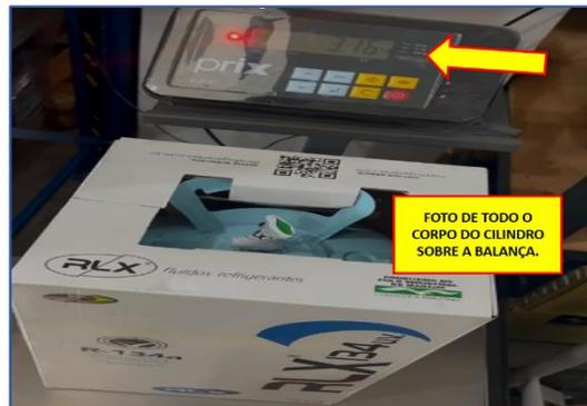
ii. Divergência de peso LATA: foto do corpo do cilindro sobre uma balança indicando o peso:
